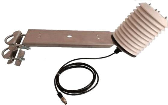
SHT3 est un senseur de température et humidité relative de l'air contenu dans un abri à ventilation naturelle.
